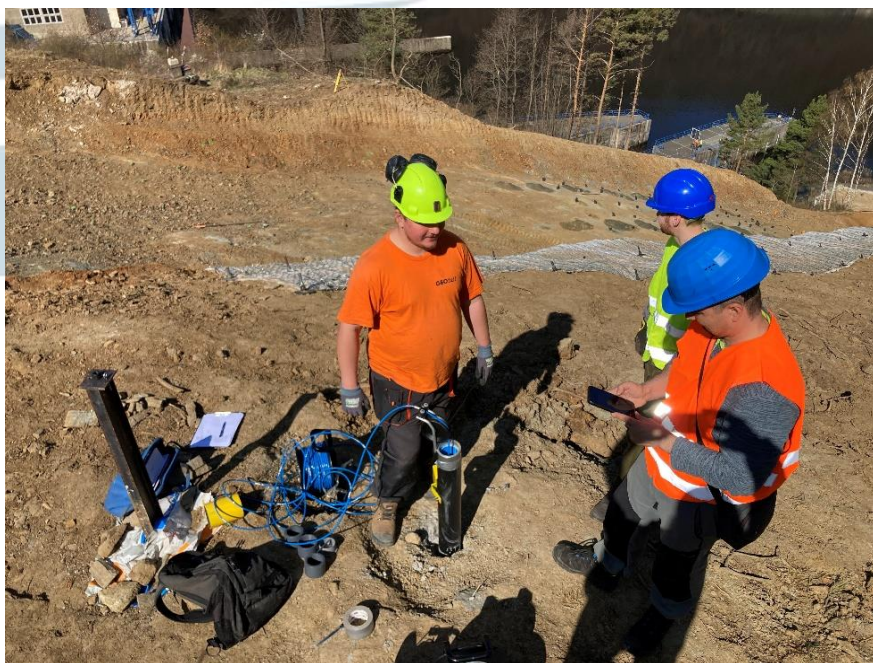
GTDI: kontrolní měření na inklinometrických vrtech
