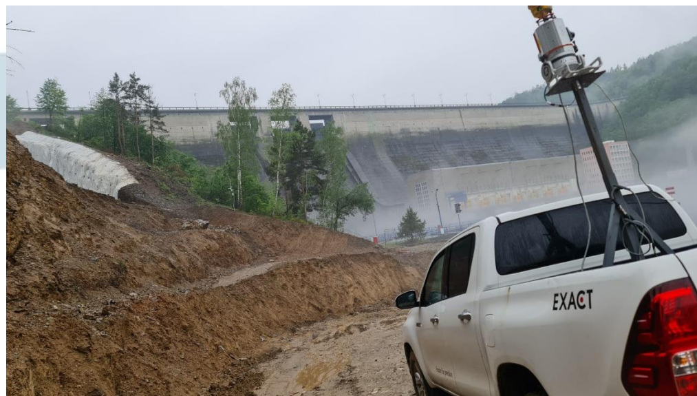
GDDI: kontrolní měření formou plošného 3D scanování
